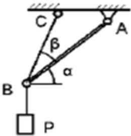
2. Груз весом  $P = 10$  Н подвешен на двух тросах АВ и ВС, составляющих с горизонтальной прямой углы  $\beta = 15^\circ$  и  $\alpha = 30^\circ$ . Определить усилия в тросах.
